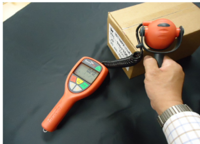
▲ 検知部を取り外しての測定
